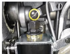
内置抬压脚机构 Built-in presser foot lifter
