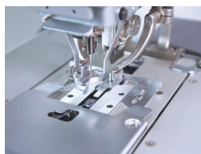
闭环系统精确控制，使圆头锁眼图案更加精美
