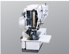
干式机头设计 Dry-head structure
